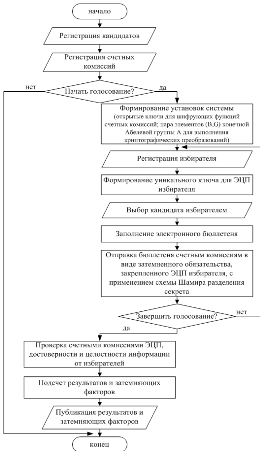
Рис. 2. – Алгоритм работы системы электронного голосования
