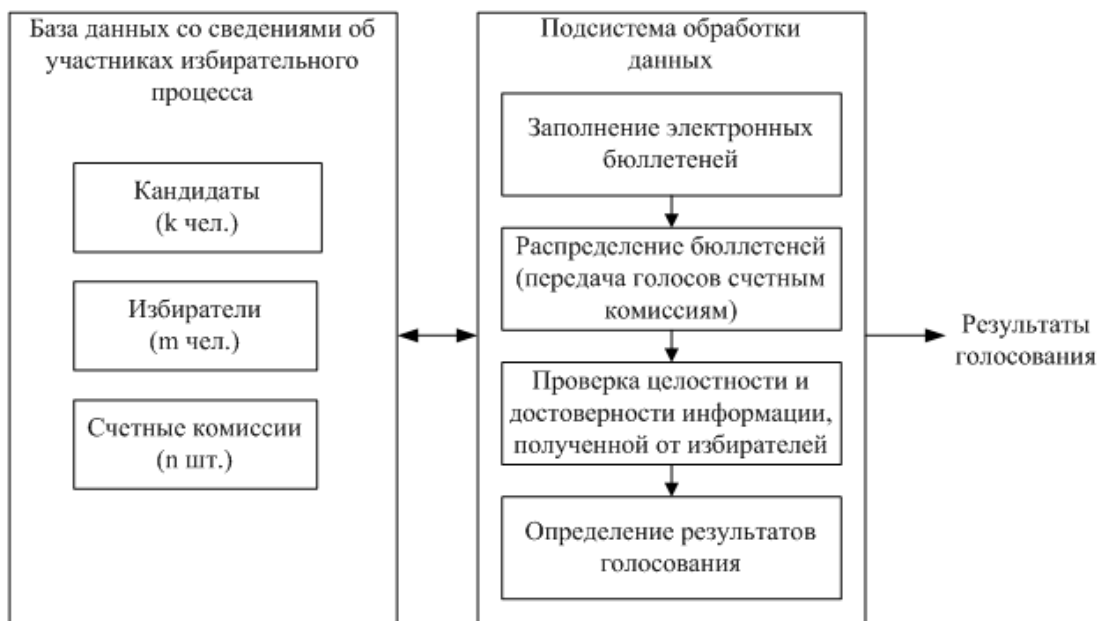
Рис. 1. Упрощенная схема системы электронного голосования
