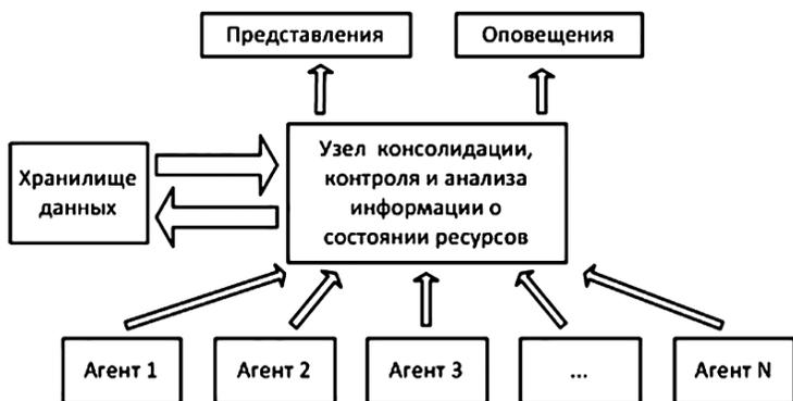
Рис. 3. Концептуальная модель системы мониторинга вычислительных ресурсов
