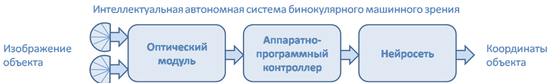
Рис. 1. Обобщенная структурная схема системы машинного зрения на основе искусственных фасеточных глаз
