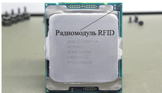
Рис. 3. Процессор Intel® Core® i9-7940X и интегрированный радиомодуль
