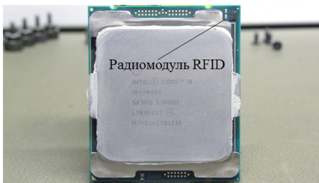
Рис. 3. Процессор Intel® Core® i9-7940X и интегрированный радиомодуль
